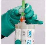
2. Statikmischer aufsetzen und mit Überwurfmutter fixieren.
