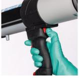
Druckentlastungsknopf vor einem Packer- oder Kartuschenwechsel betätigen.
