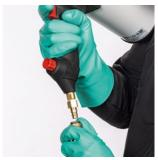
1. Druckluftkompressor anschließen.
