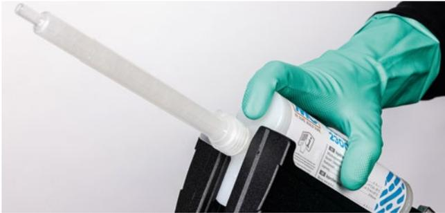
**3.** Kartusche in das MC-Fastpack Power-Tool einsetzen.
