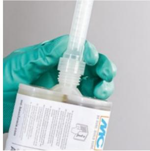
**2.** Statikmischer aufsetzen und mit Überwurfmutter fixieren.
