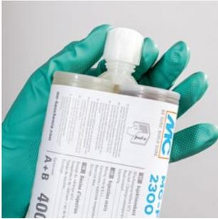
**1.** Überwurfmutter abschrauben und Sicherungsscheibe entfernen.
