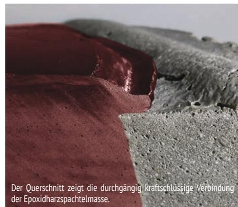
Der Querschnitt zeigt die durchgängig kraftschlüssige Verbindung der Epoxidharzspachtelmasse.
