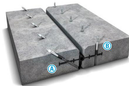
**Bohrpacker:** Packeranordnung an Bewegungsfugen mit Kreuzung des Fugenbandes. Variante **A+B**
