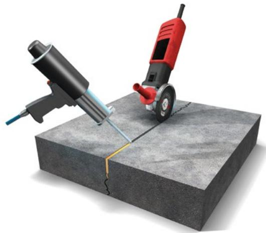
**Gravitatives Füllen:** Das gravitative Füllen erfolgt drucklos (ohne Packer). Breite Risse können direkt gefüllt werden. Schmale Risse können aufgeschnitten und gefüllt werden.
