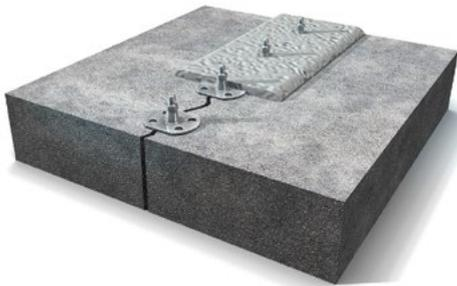
**Klebepacker:** Befestigung von Klebepackern auf der Bauteiloberfläche im Abstand der Risstiefe (mit Verdämmung)
