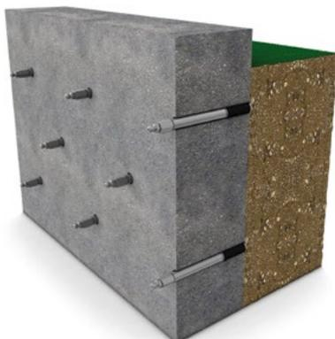
**Bohrpacker:** Packeranordnung bei Betonflächen
