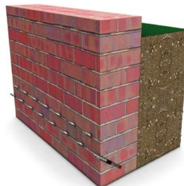
**Bohrpacker:** Packeranordnung bei Mauerwerk
